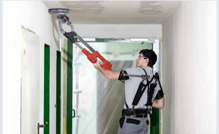
Abbildung 16: Das Paexo Shoulder von Ottobock im Einsatz am Bau
