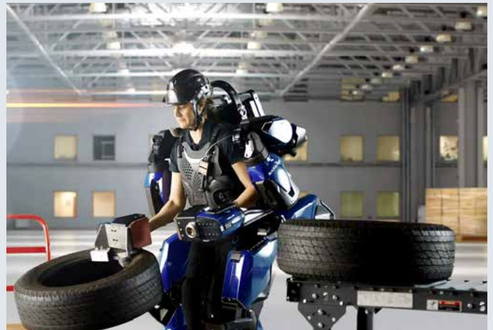
Abbildung 2: Das Exoskelett Guardian XO von Sarcos fördert die Kraft
